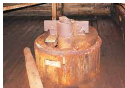
Складная матичная труба из деревянных брусьев.
