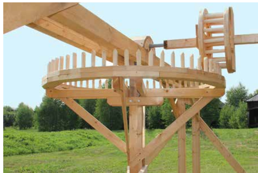
Механизм конной машины. Реконструкция. Соликамский музей истории соли.
